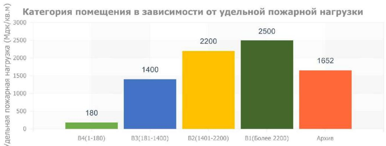
Так как выполняется условие  $1401 \leq g \leq 2200$  МДж/м<sup>2</sup> и выполняется условие Б.5, то данное помещение следует отнести к категории B1 (таблица п.Б1 СП 12.13130.2009 "Определение категорий помещений, зданий и наружных установок по взрывопожарной и пожарной опасности").
