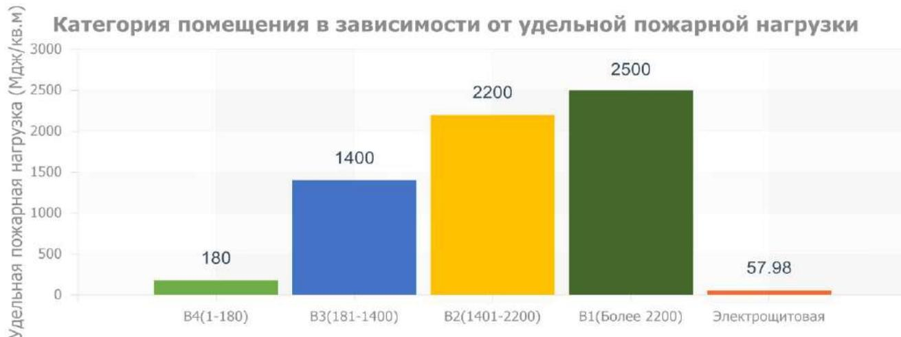
Так как выполняется условие  $g \leq 180$  МДж/м<sup>2</sup> и площадь помещения менее 10 м<sup>2</sup>, то данное помещение следует отнести к категории **V4** (таблица п.Б1 СП 12.13130.2009 "Определение категорий помещений, зданий и наружных установок по взрывопожарной и пожарной опасности").
