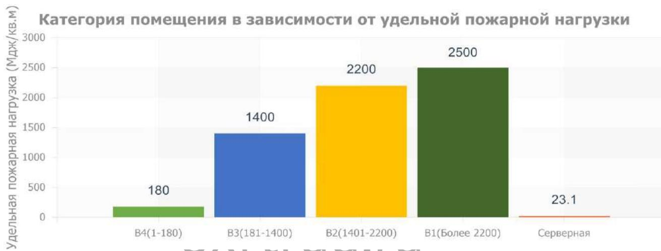
Так как выполняется условие  $g \leq 180$  МДж/м<sup>2</sup> и площадь помещения менее 10 м<sup>2</sup>, то данное помещение следует отнести к категории **V4** (таблица п.Б1 СП 12.13130.2009 "Определение категорий помещений, зданий и наружных установок по взрывопожарной и пожарной опасности").
